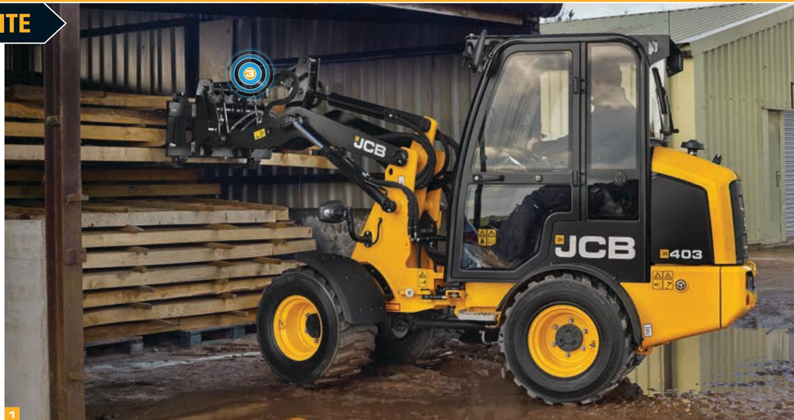
1 Avec une hauteur et une largeur inférieures à 2,2 m et à 1,1 m (dans sa configuration la plus étroite), cette nouvelle chargeuse compacte JCB 403 peut accéder aux zones opérationnelles les plus étroites.
