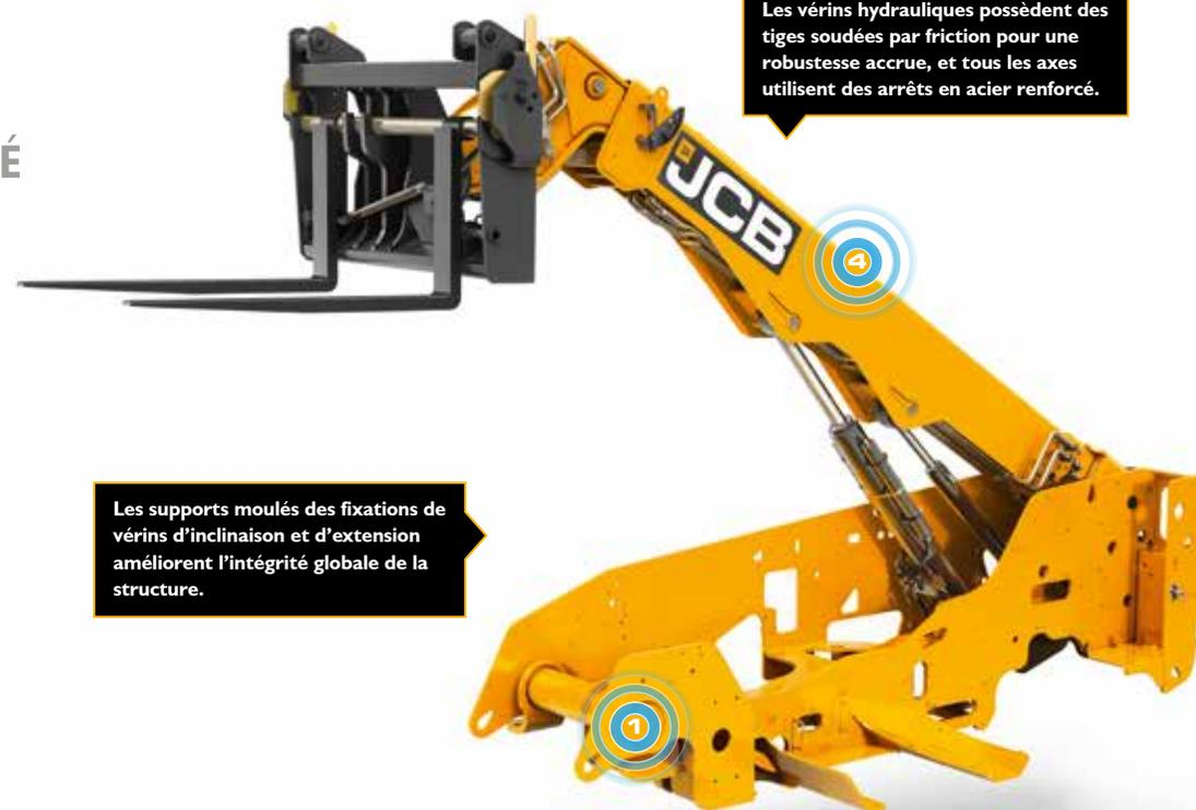
Les supports moulés des fixations de vérins d'inclinaison et d'extension améliorent l'intégrité globale de la structure.
