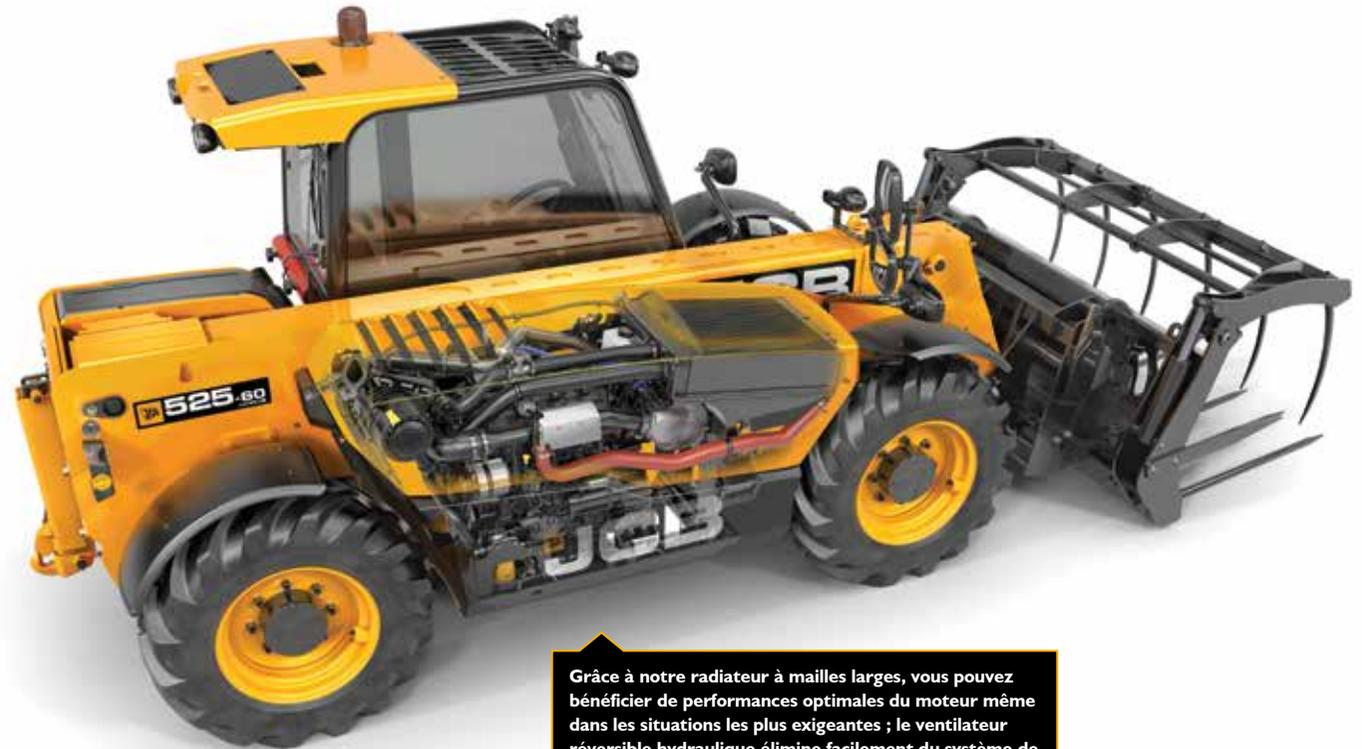
Grâce à notre radiateur à mailles larges, vous pouvez bénéficier de performances optimales du moteur même dans les situations les plus exigeantes ; le ventilateur réversible hydraulique élimine facilement du système de refroidissement les débris susceptibles de s'accumuler.
