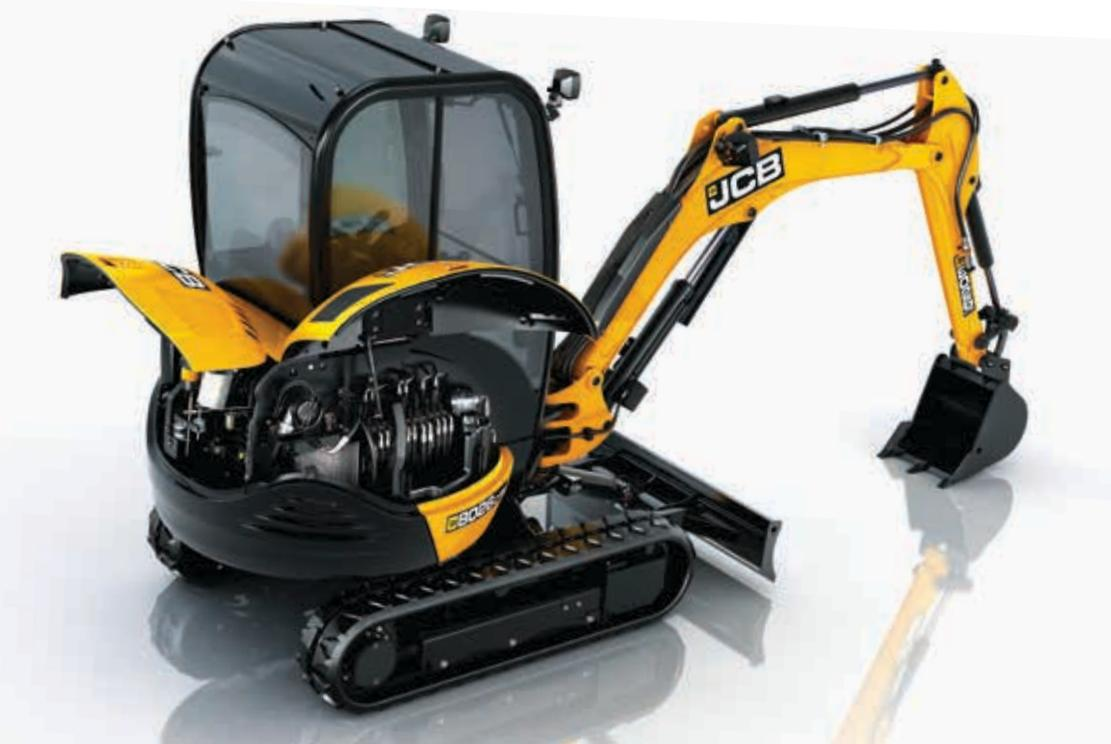
Le graissage des axes facilite la lubrification du groupe de travail. Des panneaux à ouverture large sont actionnés par des vérins à gaz, pour un accès facile aux contrôles de routine.
