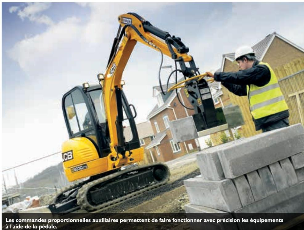
Les commandes proportionnelles auxiliaires permettent de faire fonctionner avec précision les équipements à l'aide de la pédale.
