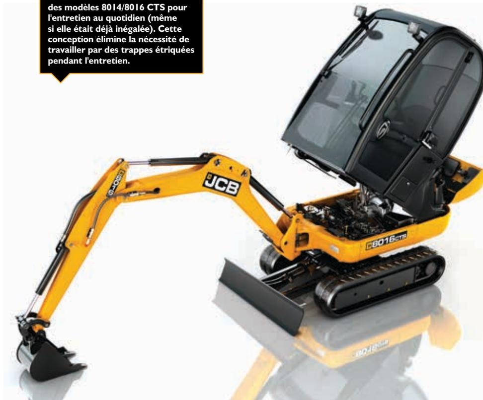
Un capot arrière à ouverture large est soutenu par un vérin à gaz pour un accès facile aux contrôles de routine.
