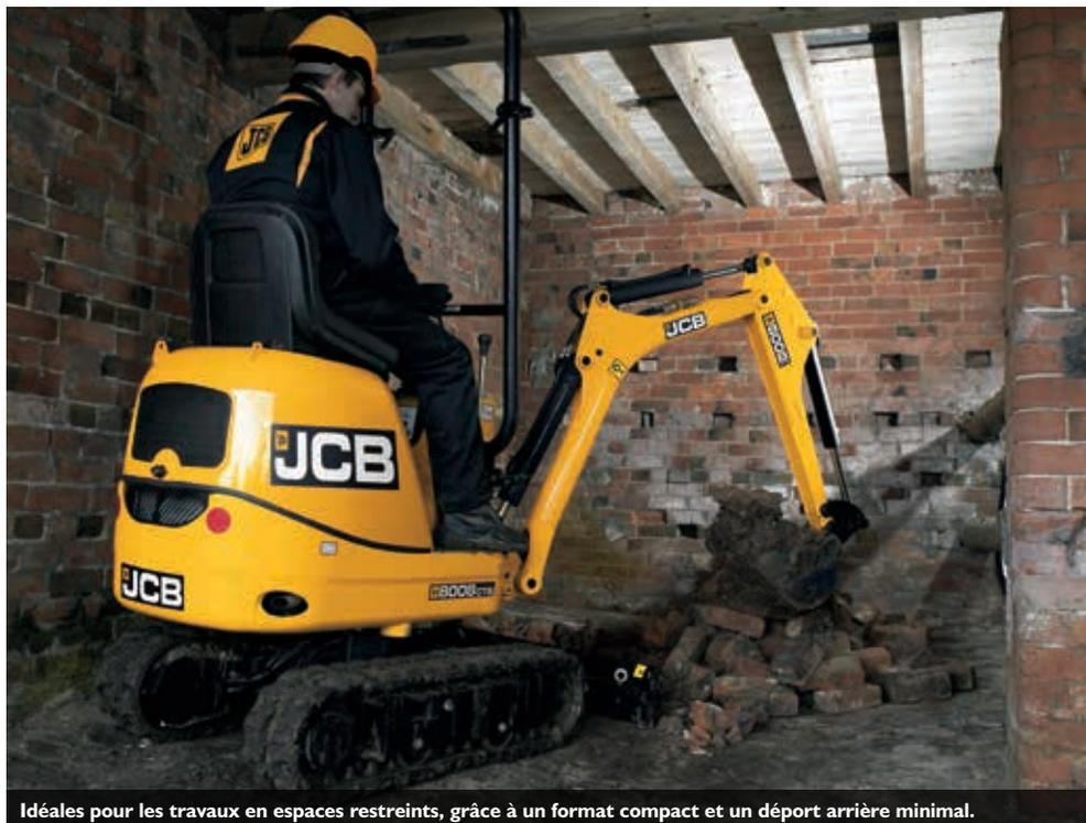
Idéales pour les travaux en espaces restreints, grâce à un format compact et un déport arrière minimal.
