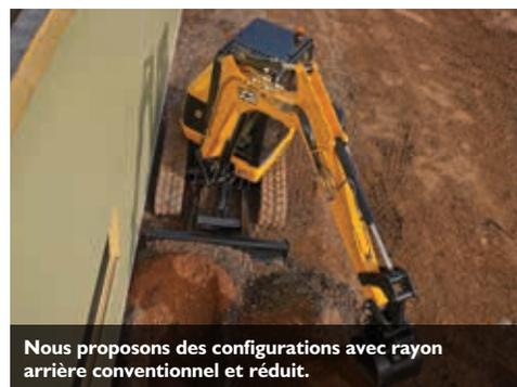
Nous proposons des configurations avec rayon arrière conventionnel et réduit.
