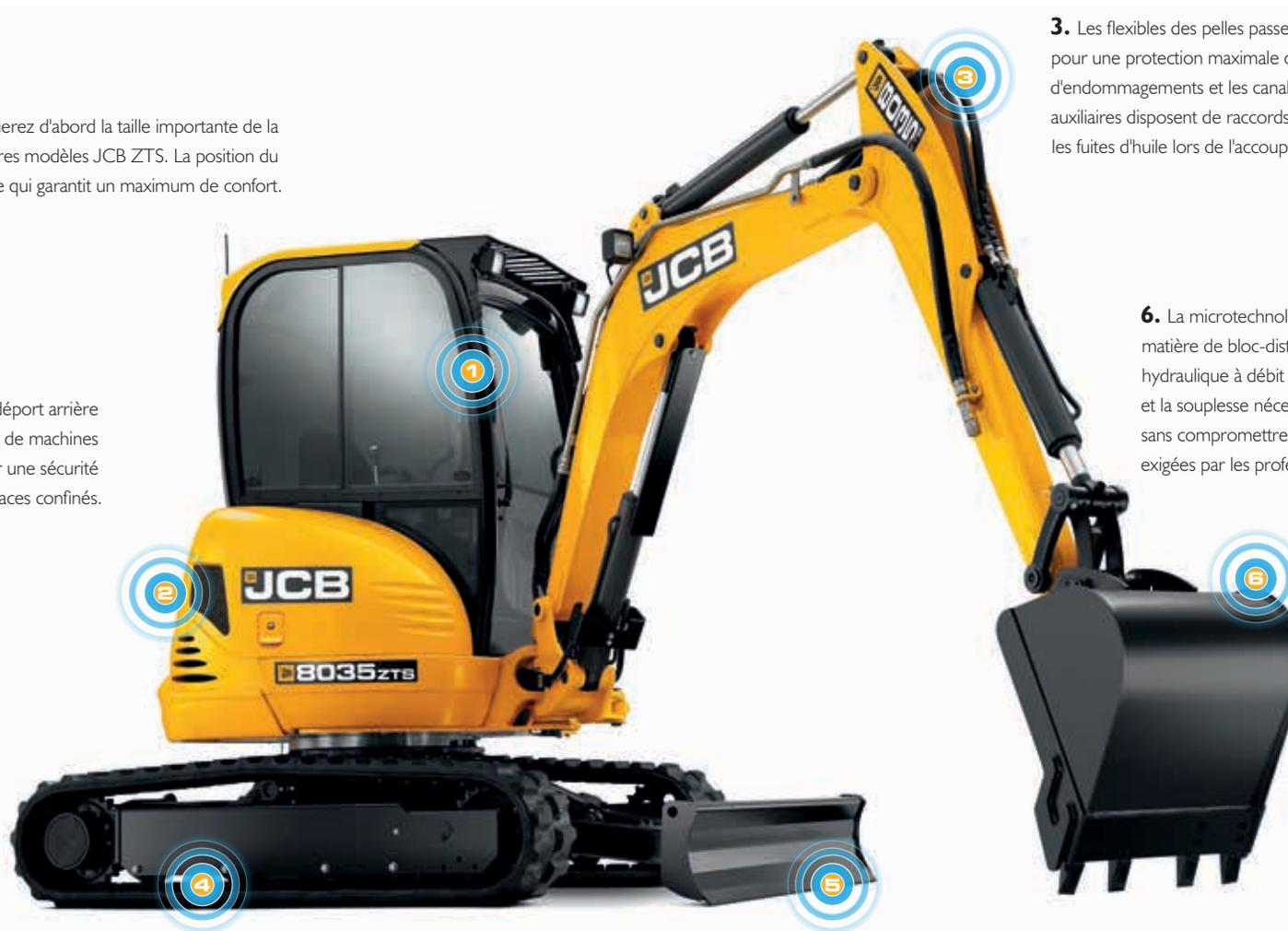
3. Les flexibles des pelles passent en haut de la flèche pour une protection maximale contre les risques d'endommagements et les canalisations des lignes auxiliaires disposent de raccords rapides qui empêchent les fuites d'huile lors de l'accouplement des équipements.
