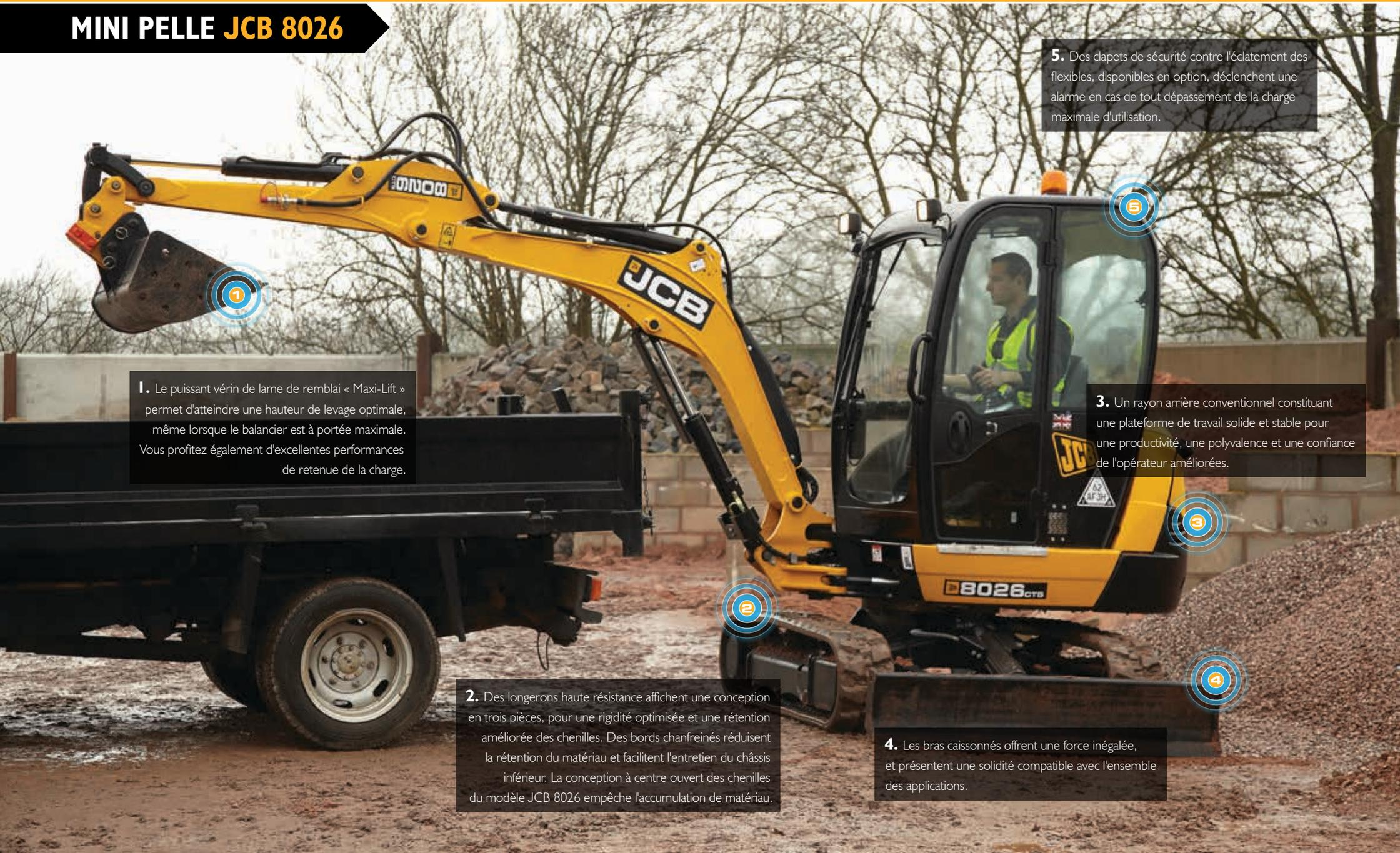
1. Le puissant vérin de lame de remblai « Maxi-Lift » permet d'atteindre une hauteur de levage optimale, même lorsque le balancier est à portée maximale. Vous profitez également d'excellentes performances de retenue de la charge.
