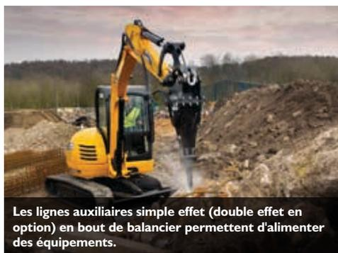
Les lignes auxiliaires simple effet (double effet en option) en bout de balancier permettent d'alimenter des équipements.
