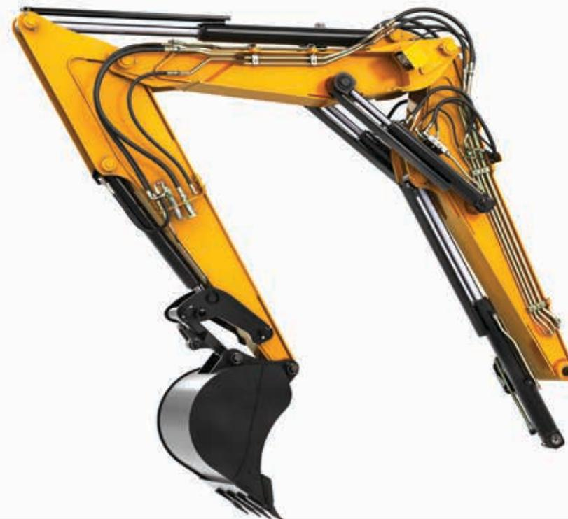
Si vous avez besoin d'une capacité de levage et d'une stabilité optimales, choisissez le modèle JCB 86c équipé, en option, de la flèche à volée variable (TAB), qui vous procurera de meilleures performances opérationnelles, en augmentant la portée de votre machine, rapprochant l'excavation et élevant la capacité de déchargement.
