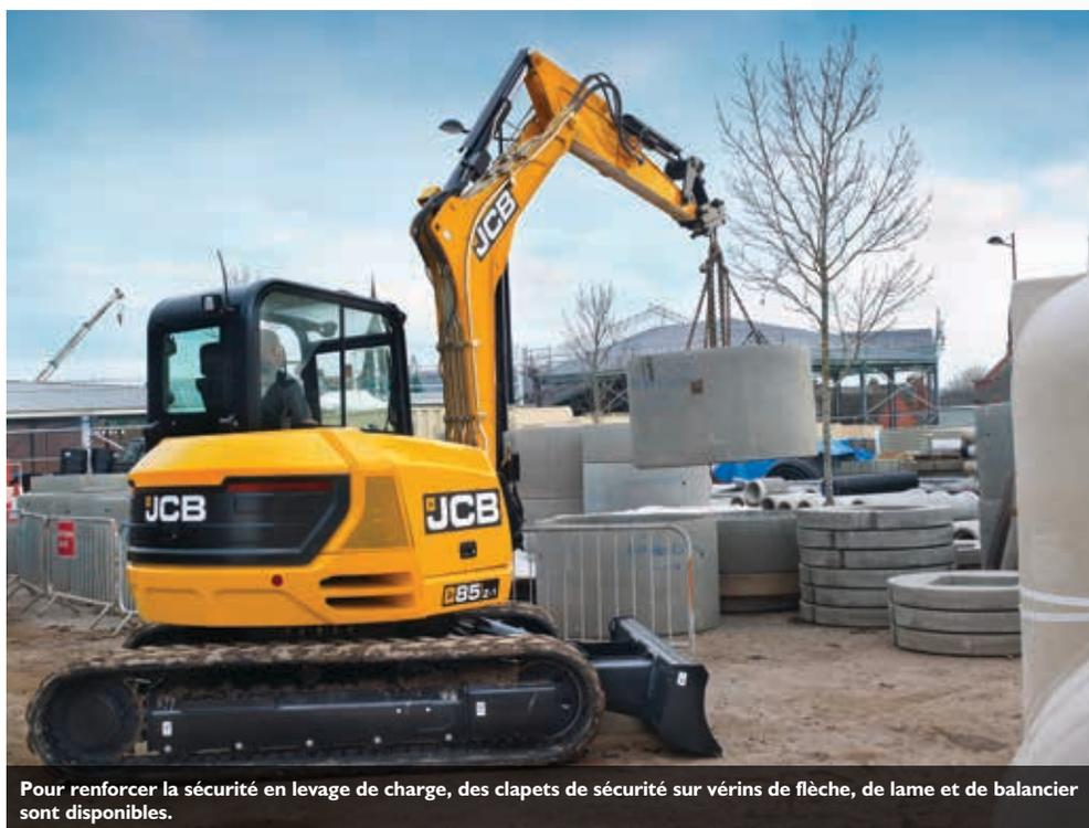
Pour renforcer la sécurité en levage de charge, des clapets de sécurité sur vérins de flèche, de lame et de balancier sont disponibles.
