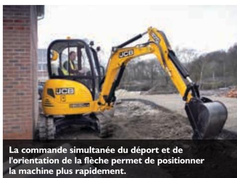
La commande simultanée du déport et de l'orientation de la flèche permet de positionner la machine plus rapidement.
