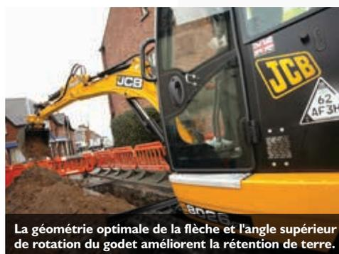
La géométrie optimale de la flèche et l'angle supérieur de rotation du godet améliorent la rétention de terre.
